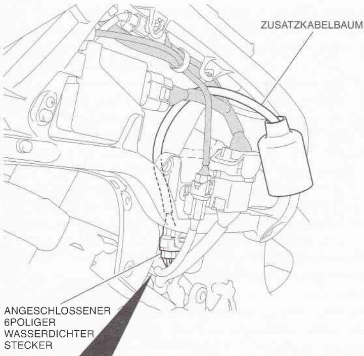
**Den Zusatzkabelbaum anschließen und in die Halteklammer einsetzen.**
