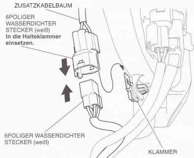
10. Die Steuereinheit anschließen, wie in der Abbildung gezeigt.
