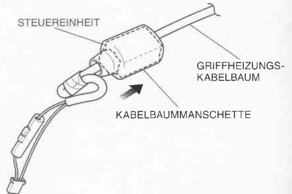
13. Den Griffheizungs-Kabelbaum durch die Kabelbaum-Manschette verlegen, dann den Griffheizungs-Kabelbaum mit dem Zusatzkabelbaum verbinden, wie in der Abbildung gezeigt.
